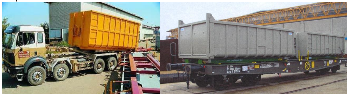
Obrázek 4 – Systém přepravy kontejnerů ACTS (autor)
