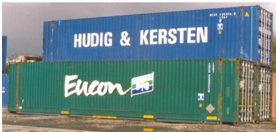
Obrázek 11 - Kontejnery ISO řady 1 E (autor)
