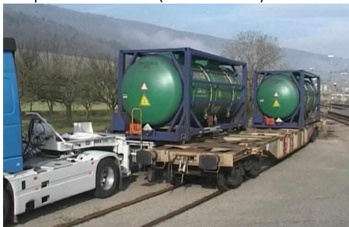
Obrázek 39 - Systém Cargo Domino ( https://www.railcargo.com )
