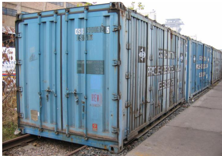
Obrázek 12 - Vnitrozemský (POOLový) kontejner pro všeobecné použití (autor)
