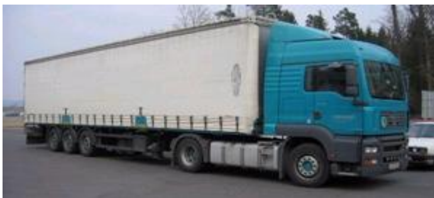
Obrázek 16 - Jízdní souprava s plachtovou výměnnou nástavbou třídy A (autor)
