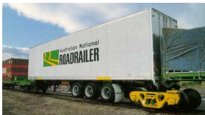
Obrázek 23 - Vlak sestavený z podvojných (bimodálních) návěsů ( https://www.litomysky.cz/ )
